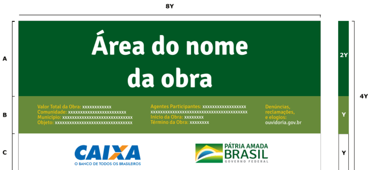
Figura 5 – Placa de obra padrão do Governo Federal
